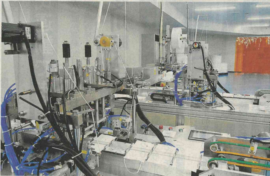
東洋産業が導入した不織布マスクの製造設備＝安八郡輪之内町楡俣、同社楡俣工場
